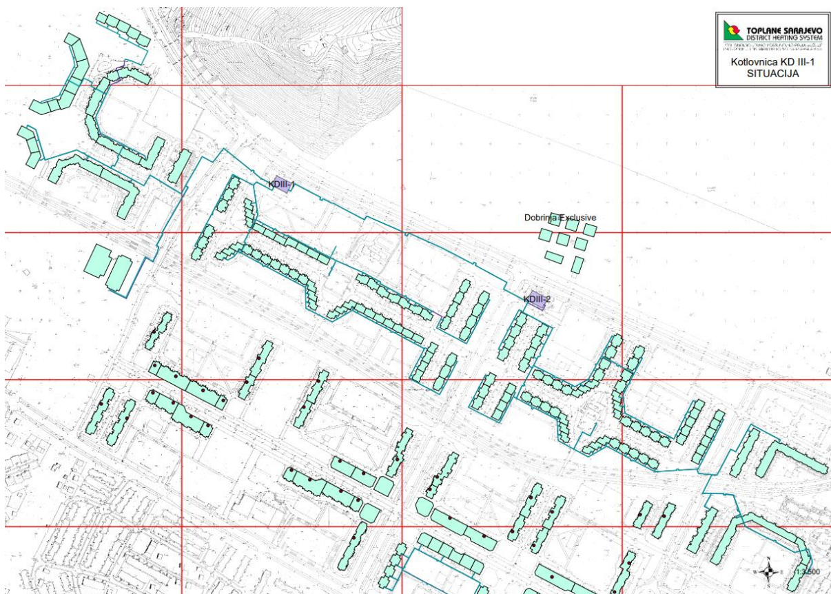
Slika 3. Situacioni prikaz kotlovnice sa postojećom distributivnom mrežom
