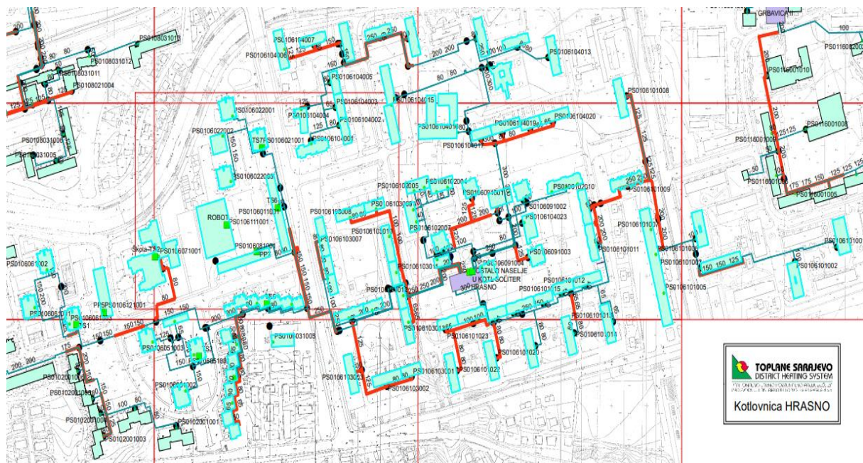
Slika 3. Situacioni prikaz kotlovnice sa postojećom distributivnom mrežom
