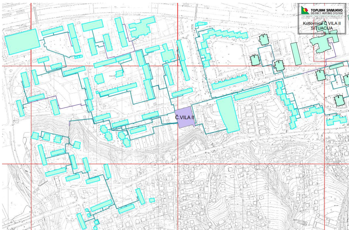
Slika 3. Situacioni prikaz kotlovnice sa postojećom distributivnom mrežom
